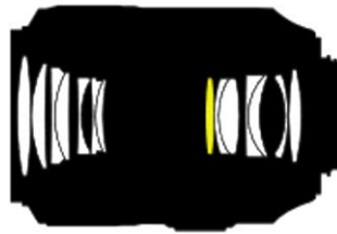
Abbildung 4: Optischer Aufbau des AF-S Micro-Nikkor 105 mm 1:2,8G ED; gelb: Linse aus ED-Glas. (Bildquelle: Nikon-Verkaufsprospekt)
